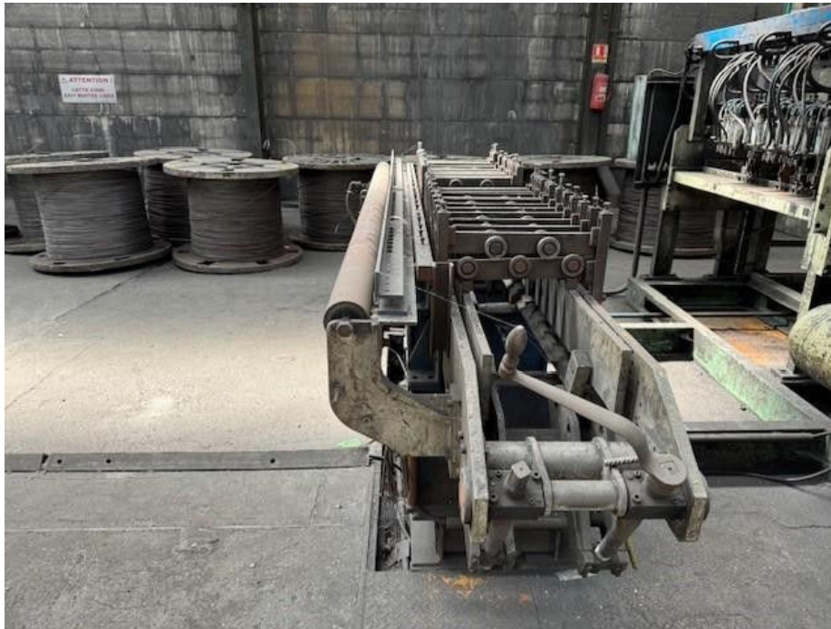
2. Unidade de endireitamento de arames longitudinais.
