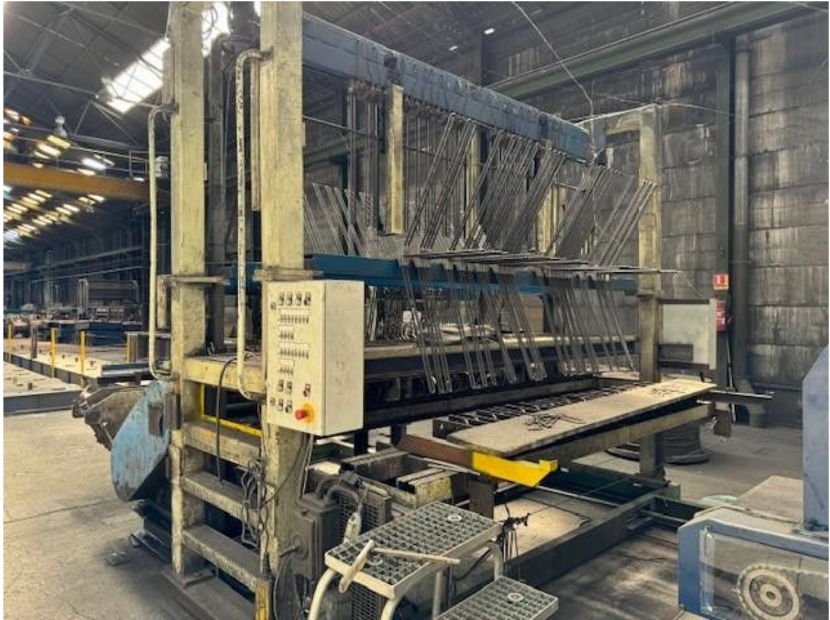
4. Pulmão (looping) para 31 arames longitudinais
