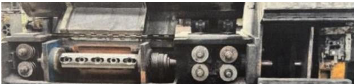
3. Sistema endireitamento e corte para os arames transversais.
