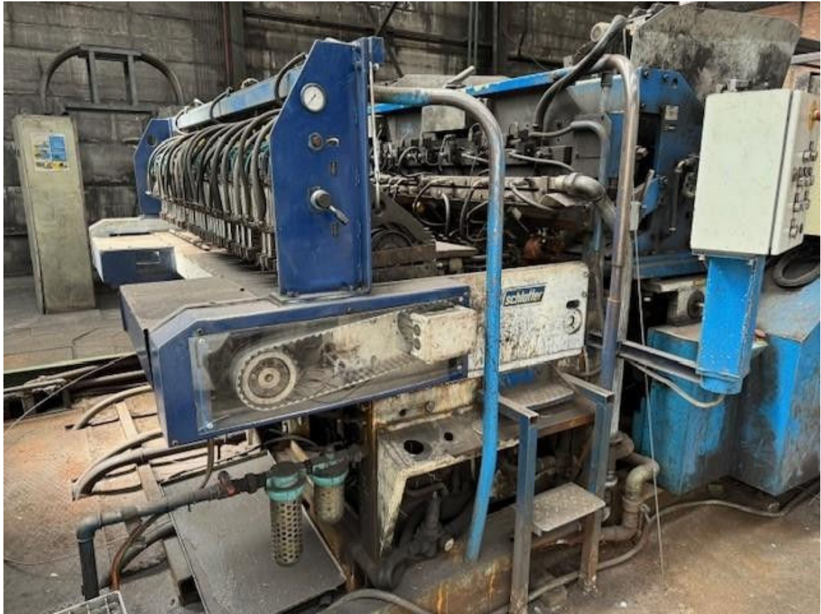
5. Um sistema de alimentação dos arames longitudinais controlado por cnc
