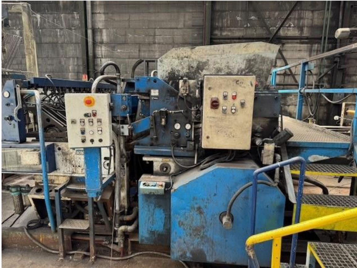
6. Magazine de arames transversais e tesoura guilhotina da Tela
